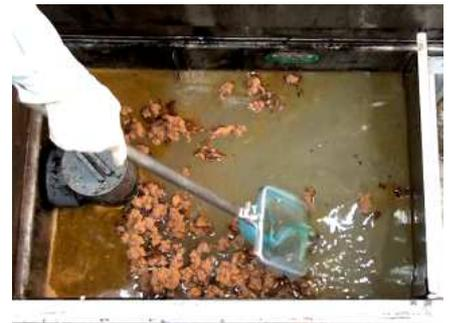
強くかき混ぜず、エコツーと油を優しく寄せ集めれば即座に油を吸着。あとはスクーパーで回収。
