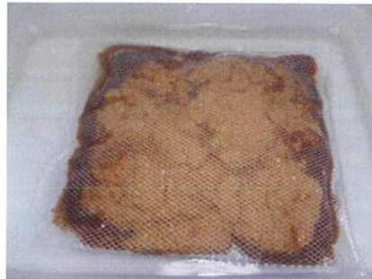
半分程度油を吸った状態 焦げ茶色の部分が油を吸った部分 まだ吸着余地があり裏返して使用可能
